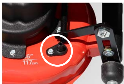
白丸で囲ってある洗浄ポートにホースをつなぐことで、デッキ内に水を流して掃除をすることができます。
