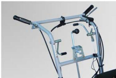
走行速度、作業速度はハンドル部にあるチェンジレバーを切り替えることで調整できます
