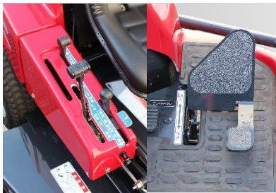
フットペダル・手動レバー連動型で、スピード調整、前後進はフットペダルまたは走行レバー操作のどちらでも可能です。
