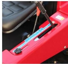
刈高は目安ラベルに合わせ、刈高レバーでワンタッチ調整可能です。（ストッパー付）
