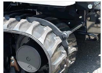
クローラー外れ防止バーが、傾斜地でのクローラー外れを防止します。
