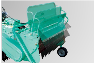
刈取部の調節カバーは、草丈に応じて3段階調整が可能です。
