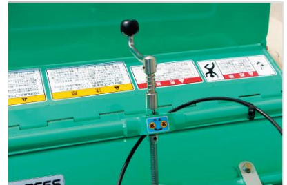
刈高調整は、モア部にあるハンドルを操作するだけの簡単調整です。
