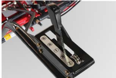
走行速度・作業速度は、チェーンレバーを切り替えることで調整できます。
