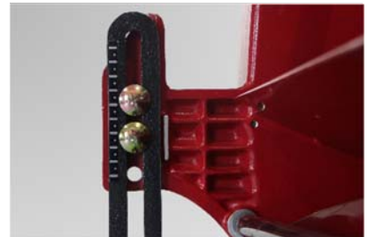
刈高は、前車輪ブラケットのメモリを左右同じ場所に合わせるだけなので、簡単に調整できます。（写真はLM81TA）
