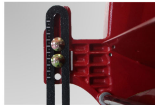
刈高は、前車輪ブラケットのメモリを左右同じ場所に合わせるだけなので、簡単に調整できます。（写真はLM81TA）
