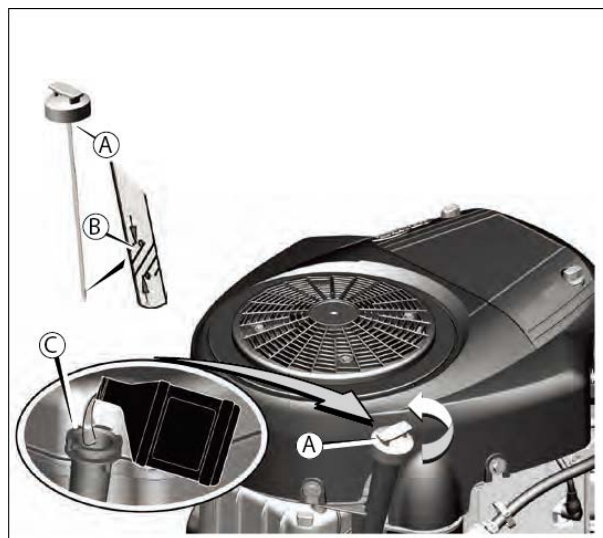
図 4 オイルの点検と補充
