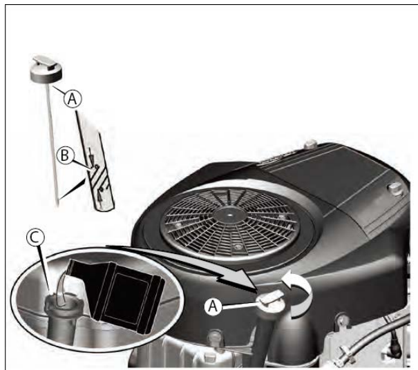
図 4 オイルの点検と補充
