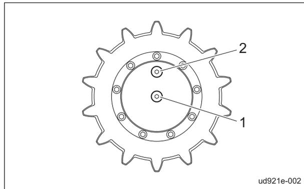
油圧モーターのギヤオイルの交換\_002
