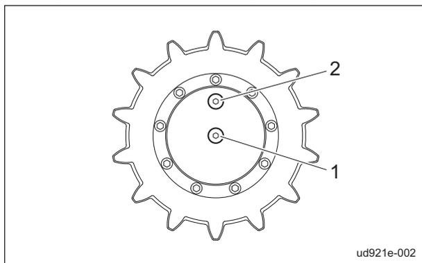
油圧モーターのギヤオイルの点検\_001
