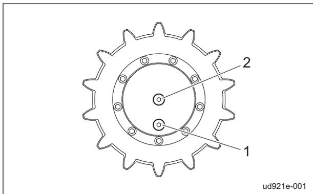
油圧モーターのギヤオイルの交換\_001
