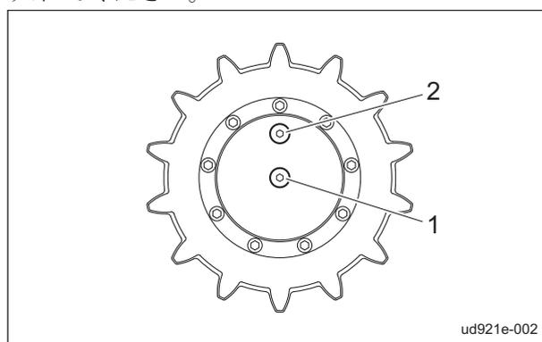
油圧モーターのギヤオイルの補給\_001
