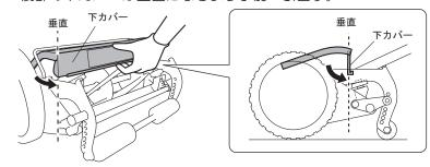
③ 下力バーが受刃調整ツマミの内側に入るようにカバーを「カチッ!」と音がするまで下方向へ押込んで閉める。
