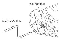
⑧「3-3 刃合せの状態を確認する」を参照し、回転刃と受刃の左部・中央部・右部の3カ所で刃合せを確認します。
