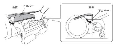
③ 下力バーが受刃調整ツマミの内側に入るようにカバーを「カチッ!」と音がするまで下方向へ押込んで閉める。
