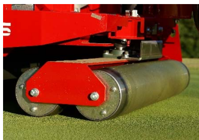
大径ローラー（操舵輪）の採用により接地圧の集中化を防ぎ、グリーン面を傷めません。グリーンの地面をならし、パッチングクオリティを向上させます。
