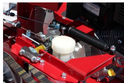
ダンパーシステムを採用することで作業時の急停止を抑制し、グリーンの端々を傷めません。ペダルを離せばすぐに走行が停止する現象をあえてなくしました。（調整可能）
