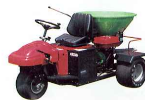
MS300 乗用薄目砂散布機 241万5000円 芝が生き活き育つためには、たまに砂を入れてやるのだとか。世の中、まったくもって知らんこと多いなあ。後ろのシッポで砂を撒いていきますよ。
