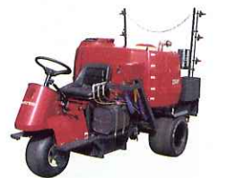
TS500 ターフスプレーヤー 372万7500円 街の自警団の消防車にあらず。殺菌剤や成長抑制剤の散布に適し、少しの薬で芝の病気を防ぎます。冬のゴルフ場を緑に変えるのも得意だそう。
