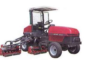
LM745F 四輪駆動油圧式トラクターモア 1036万3500円 超絶の刈り幅4.5メートルを実現。広大なゴルフ場のフェアウェイをスピードで刈り込みます。オーバー1000万、芝刈り機界のメルセデスか？
