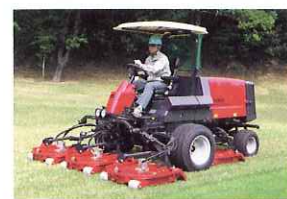
GM2800 乗用5連ロータリーモア 981万7500円 草刈機では最大の刈り幅2.8mを実現しながら、小回りが効きゴルフ場のバンカー周りも刈り込みます。4気筒ディーゼルトーボエンジン搭載で走り自信あり。
