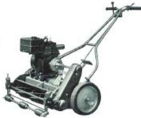
Baroness Greenmower は芝割の中でも最も手入が必要と云はれるゴルフ場のグリーン用として特に設計されたもので、高麗芝を最小50cmの長さにむらなく鏡の面のように割ることが出来ます。芝刈機の生命である刃には磨耗の極めて少いクロムタンゲステン鋼を使用し伝動部には精管加工されたギヤを取りつけている故、すべての部分にわたって実用的見地から種々の改良工夫が加えられた、グリーンモアーの最高級機との好評を頂いております。
