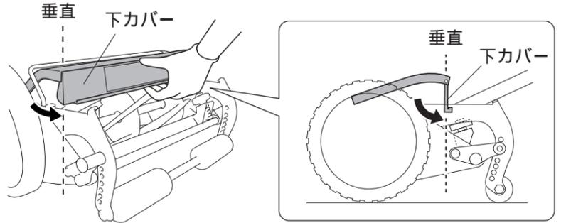
・下カバーが受け刃調整ツマミの内側に入るように、カバーを「カチッ！」と音がするまで下方向へ押し込んで閉めます。
