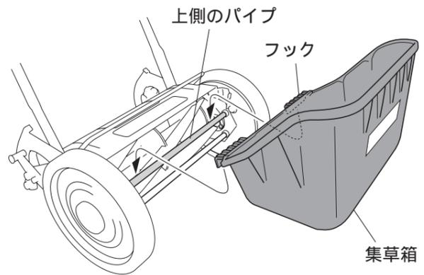
・次に集草箱の前面下部にある突起部が下側のパイプの下へ入るように集草箱をしっかりと取り付けます。
