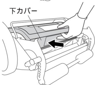
・カバーの後部の下カバーを内側へ押さえる。
