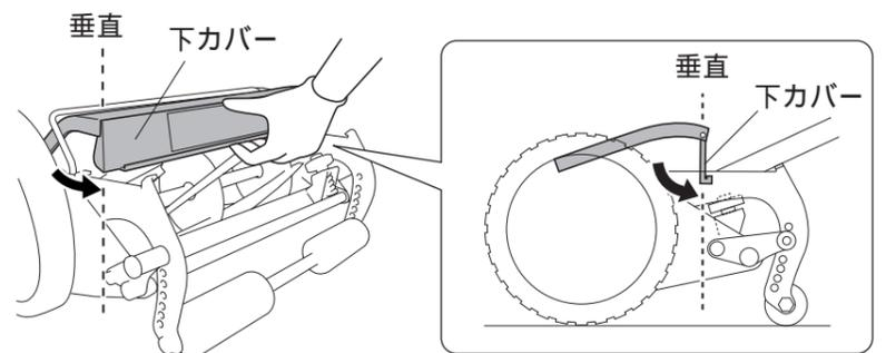
・下カバーが受け刃調整ツマミの内側に入るようにカバーを下方向へ押し込んで閉めます。集草箱を取り付けると刈り込み作業が行えます。
