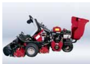
ボンネット、シート下カバーが大きく開きますのでメンテナンスが容易にできます。
