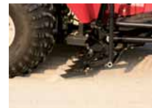
カルチベータ 固く締まったバンカーの表面をほぐして、砂を柔らかく仕上げます。
