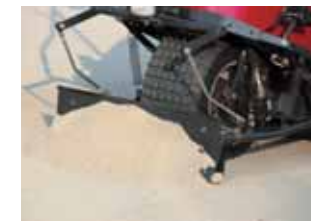
排砂板 手動式で微調整が可能、軽く扱うことができます。 取り外しも簡単です。
